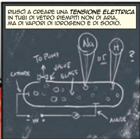
RILUSCI A CREARE UNA TENSIONE ELETTRICA IN TUBI DI VETRO RIEMPIITI NON DI ARIA, MA DI VAPORI DI IDROGENO E DI SODIO.
